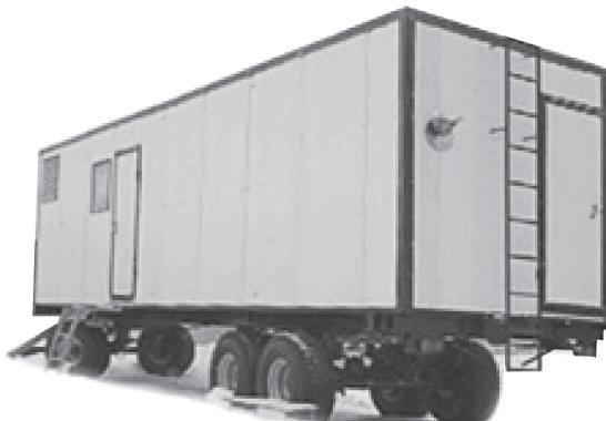
Рис. 6.4. Передвижная установка генерации синтетического природного газа Metan-M-2-1-1400-СК
